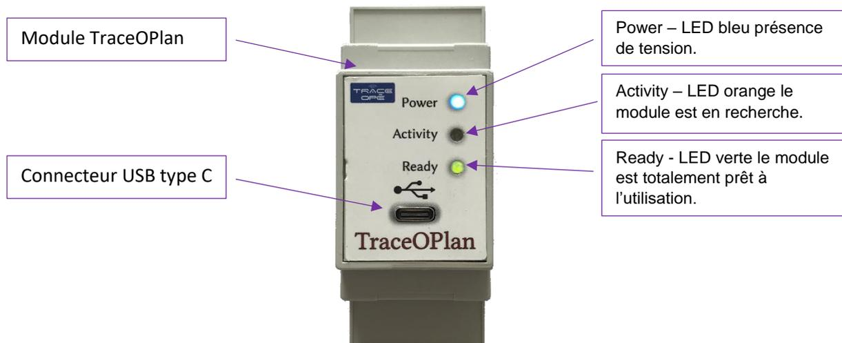
TraceOPlan est un référentiel pour les installations techniques. Il se place dans les coffrets électriques, les baies réseaux et toutes sortes d'installations.
