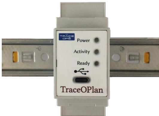
Pour installer le TraceOPlan il faut juste « cliper » le module sur le rail (voir photo n°1)
